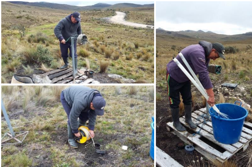
Figura 6-199 Toma de Muestras de Aguas Subterráneas en los Piezómetros de Monitoreo
